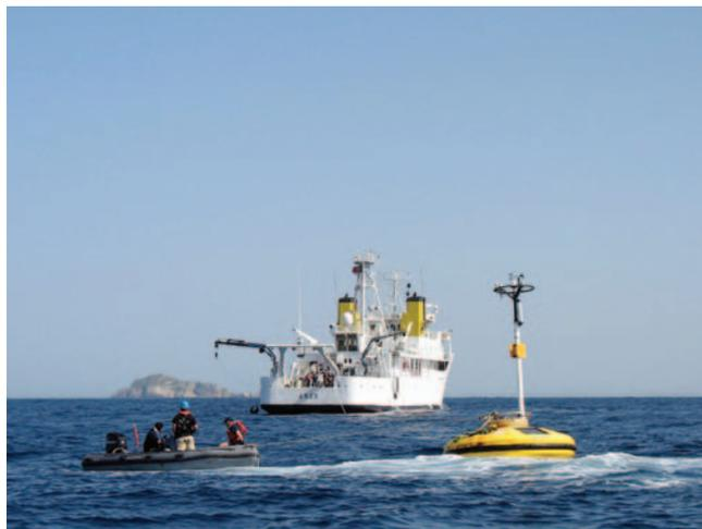
Fig. 15 - Fundeamento de instrumentação oceanográfica, pelo navio hidrográfico “Almirante Gago Coutinho”
